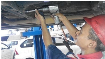
Gambar 18. Membuka klem kabel transmisi
