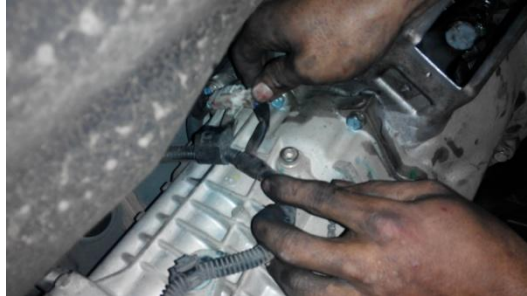
Gambar 15. Membuka kabel kelistrikan transmisi
