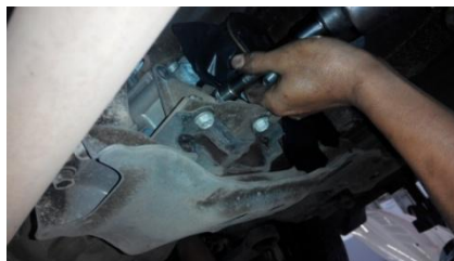
Gambar 17. Membuka baut mounting transmisi
