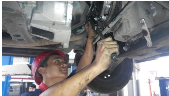
Gambar 43. Proses pengencangan baut clutch cover
