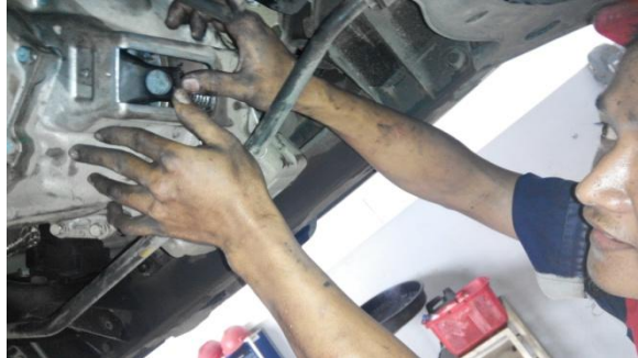
Gambar 26. Membuka release fork dan bearing
