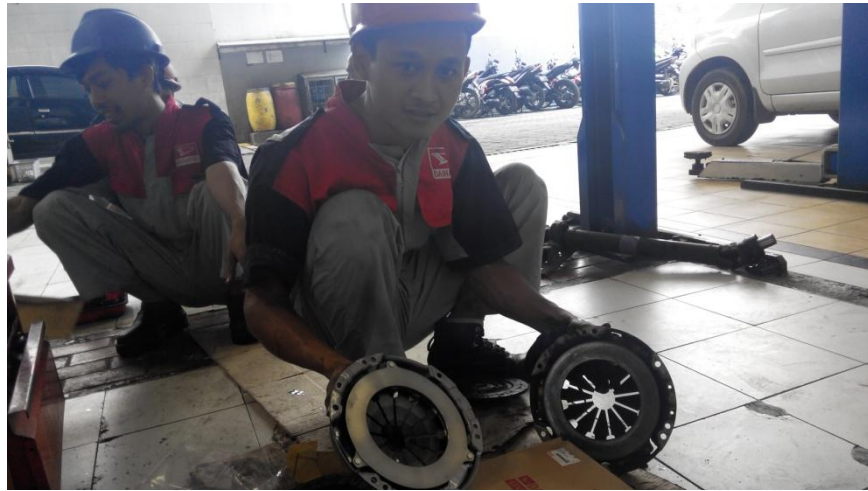
Gambar 40. Clutch cover yang harus diganti
