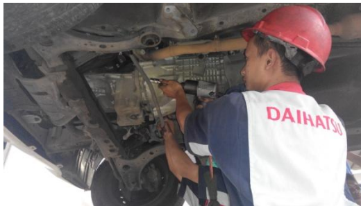
Gambar 24. Membuka baut pengikat transmisi
