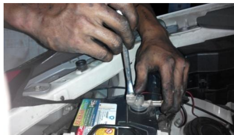
Gambar 13. Melepas terminal negatif (-) baterai
