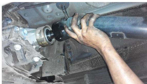
Gambar 21. Melepas yoke dari transmisi
