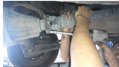
Gambar 20. Membuat tanda dan melepas flange yoke
