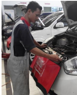
Gambar 12. Pemasangan fender cover
