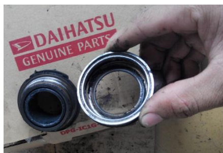
Gambar 38. Bearing yang sudah tidak layak pakai
